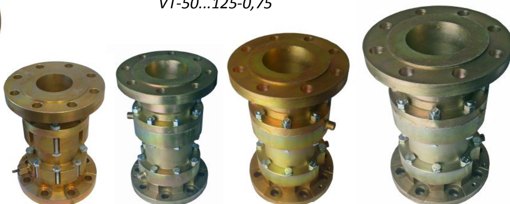
Датчики расхода пара и газа (трубы Вентури) на принципе переменного перепада давления
