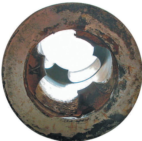
Датчик расхода FS-32T после 10-ти летнего периода эксплуатации, очищенный с одной стороны
